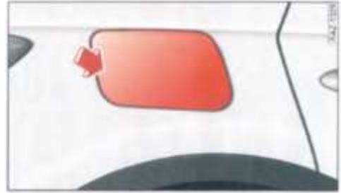
الصورة 83 جانب السيارة من الخلف ومن اليمين: فتح غطاء الشحن بالجهد العالي
