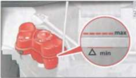
الصورة 153 المقصورة الأمامية: حاوية انتشار سائل التبريد (رسم تخطيطي عام)
