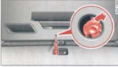
الصورة 32 واجهة باب صندوق السيارة: ممر تحرير إقفال الطوارئ
