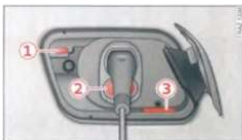
איור 84 יחידת טעינה: חיבור טעינה הרכב ומחזון טעינה
