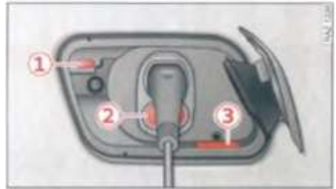
الصورة 84 وحدة الشحن: توصيل شحن السيارة ومؤشر الشحن
