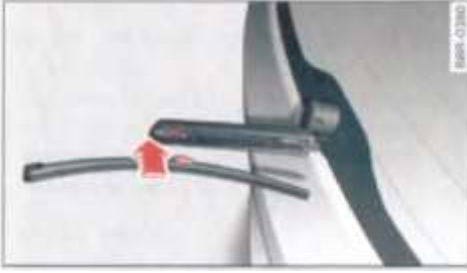
الصورة 46 ماسحة الزجاج الخلفي: تركيب شفرة ماسحة زجاج السيارة
