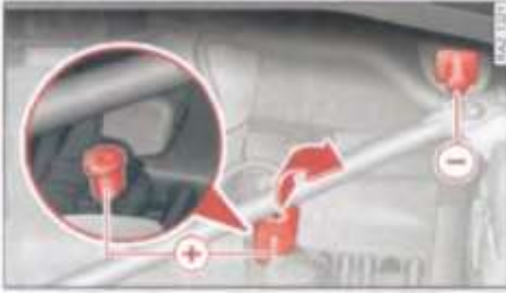
الصورة 155 سطح أمامي: وصلات بكوابل الشحن أو كوابل القفز
